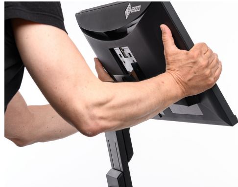
Ne így, kérlek! Állványra szerelés esetén jobb, ha a kijelzőt biztonságosan egy felületre helyezi.
